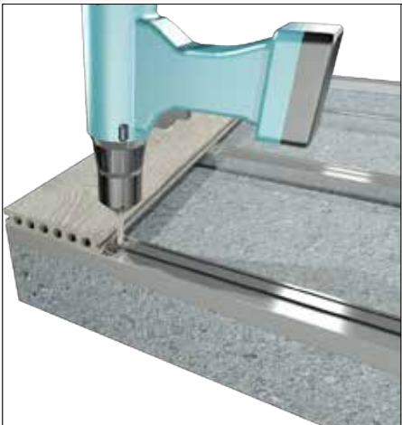
2) Schrauben Sie die Stahlclip fest
