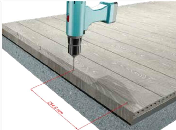
7) Führen Sie Bohr- und Schraubarbeiten alle 254,5 mm durch
