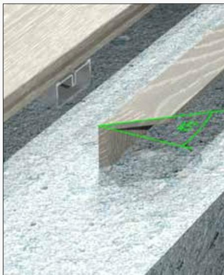
2) Aussehen des Eckprofils nach dem Schneiden
