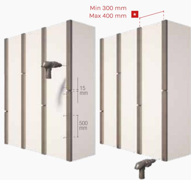
Installieren Sie die Aluminiumträger auf einer regelmäßigen und glatten Oberfläche. Beachten Sie die Abstände wie in der Zeichnung gezeigt.
