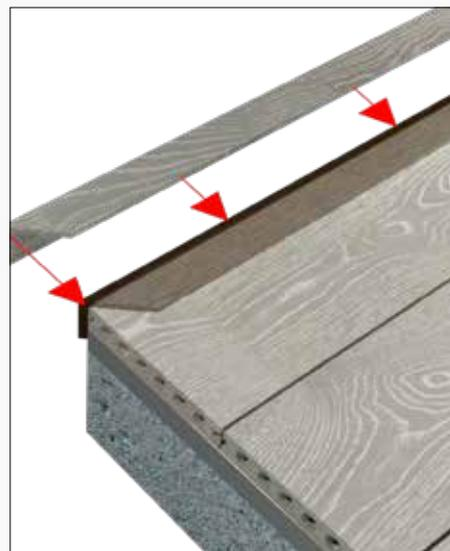
3) Bringen Sie das erste Eckprofil (kurze Seite) an und passen Sie es korrekt an die Latte an
