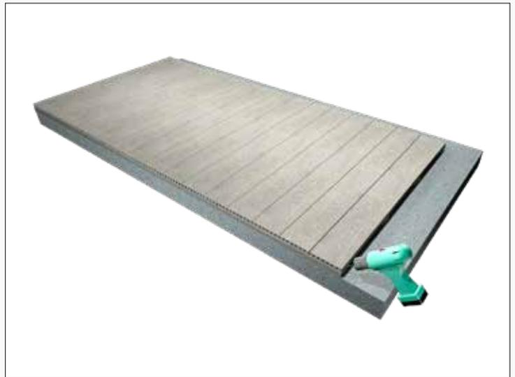
2) Bohren Sie den Schlitz der letzten Latte und des Trägers mit einer Neigung von mehr als 45 Grad mit einem 3mm Holzbohrer
