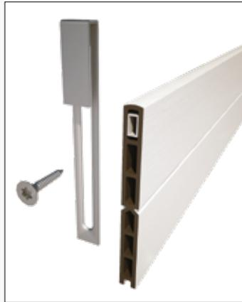
Positionieren Sie das Verschluss-Kit im oberen Teil und befestigen Sie es mit der Schraube im Verstärkungskern.
