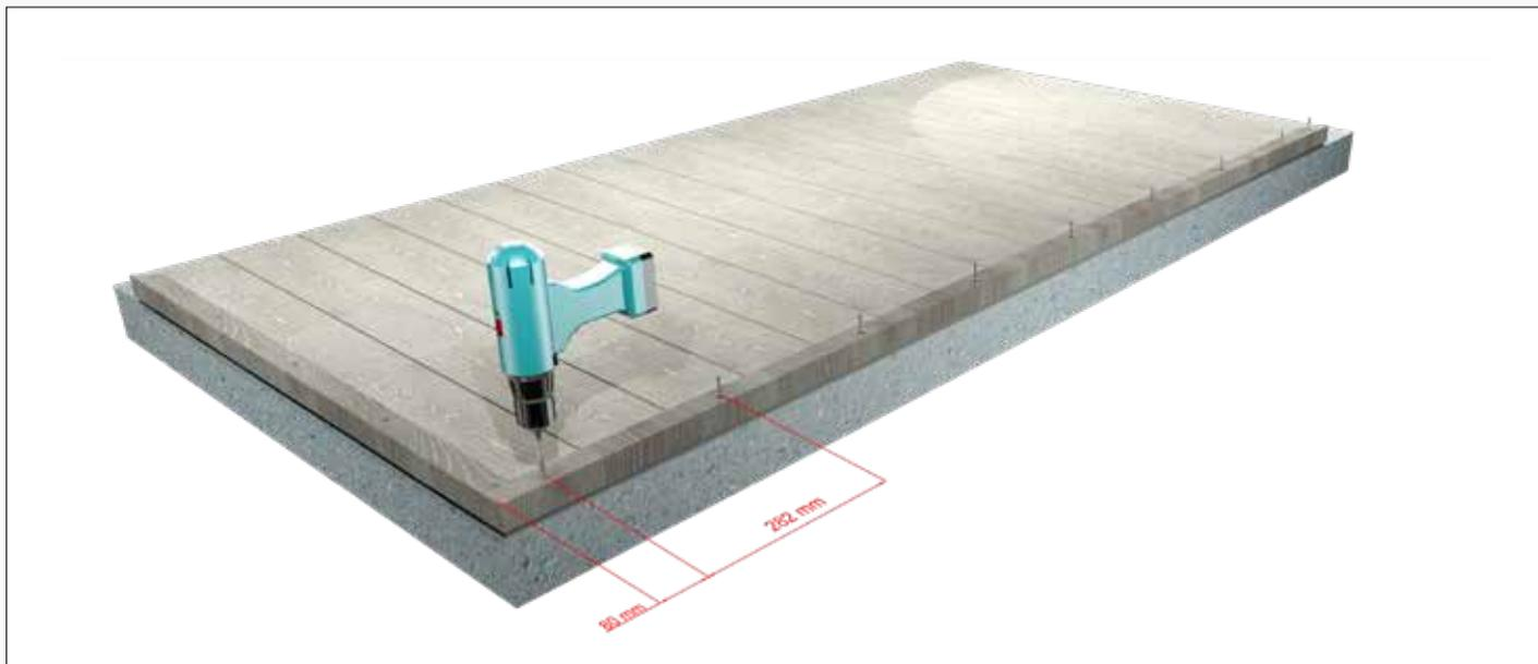
10) Führen Sie Bohrarbeiten (3 mm Bohrer) und Verschraubungen am gesamten "langen" Eckprofil etwa alle 282 mm durch. Denken Sie daran, immer die mitgelieferten Kunststoffunterlegscheiben anzubringen.
