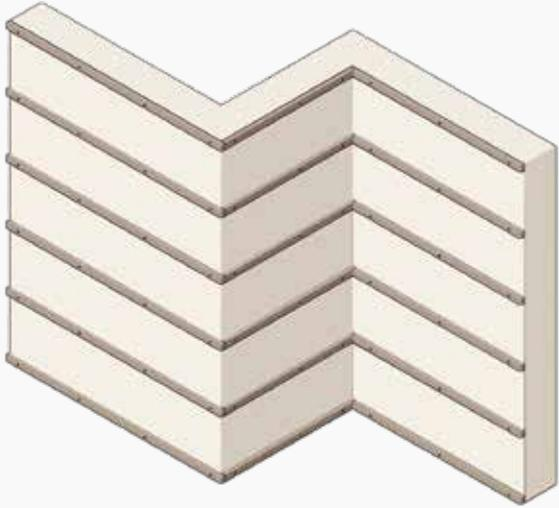
Befestigung der Träger mit maximalem Achsabstand von 40 cm.
