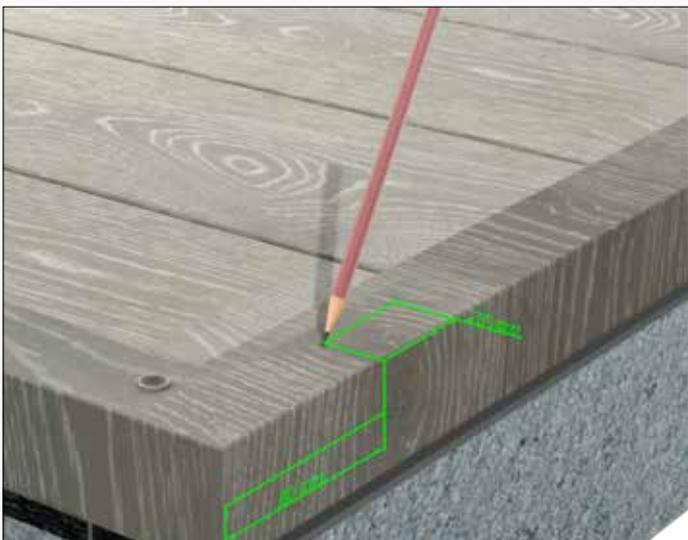
8) Bringen Sie das zweite Eckprofil (lange Seite) an und stellen Sie sicher, dass es mit dem ersten verlegten Eckprofil übereinstimmt. Maße rein indikativ.
