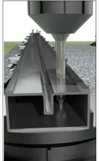
1) Bohren Sie in einem bestimmten Abstand von 350 mm, wobei Sie die Löcher immer rechts und links zur Mittelachse abwechseln, die obere Fläche des Trägers mit einem 10 mm Metallbohrer, die untere Fläche mit einem 3 mm Bohrer, danach eine 25 mm Schraube einsetzen, um den Träger selbst zu befestigen.
