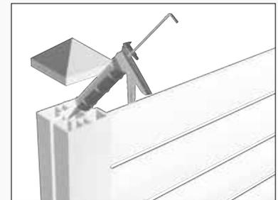
Schließen Sie die Oberseite der Säule mit einer Verschlusskappe mit Schrauben oder zweikomponentigem Epoxidkleber.
