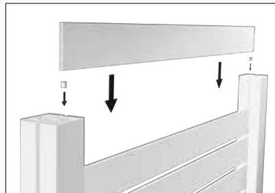
Zwischen einer Latte und der anderen müssen Abstandshalter eingefügt werden, indem sie von oben in die Kanäle der Säule eingefädelt werden.
