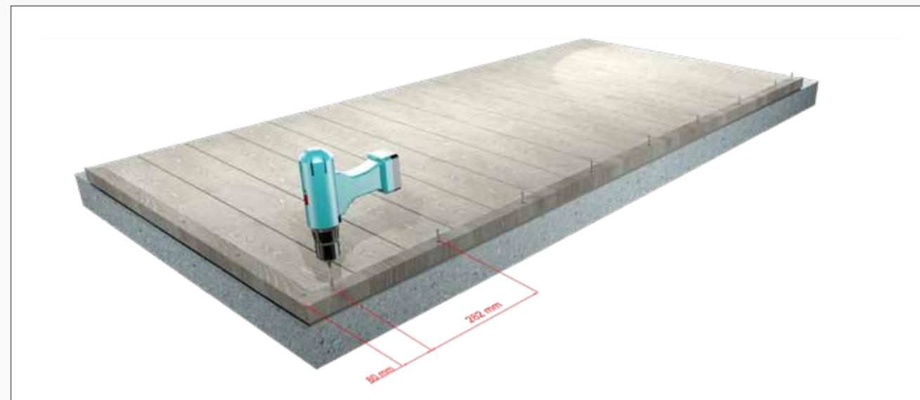
10) Eseguire lavorazione di foratura (punta da 3 mm) ed avvitatura su tutto l'angolare "lungo" ogni 282 mm circa. Ricordarsi di applicare sempre le rondelle in plastica fornite.
