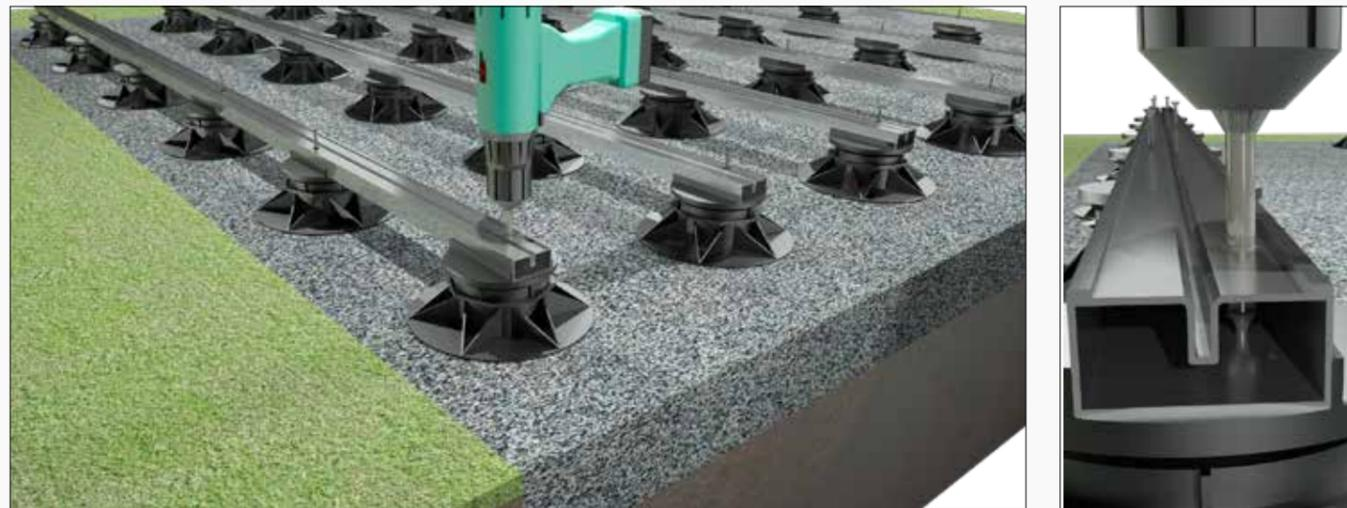
1) Forare ad una certa distanza di 350 mm, alternando sempre i fori a destra e sinistra rispetto all'asse centrale, la faccia superiore del magatello con punta da metallo di 10 mm, la faccia inferiore con punta da 3 mm, dopo di ch  inserire una vite da 25 mm per fissare il magatello stesso.
