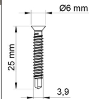
Vite da utilizzare per fissaggio angolari
