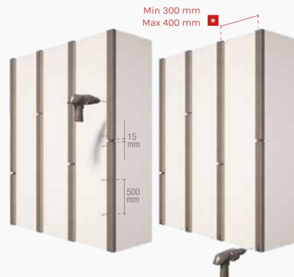
Installare i magatelli in alluminio in una superficie regolare e liscia. Rispettare le distanze come da disegno.
