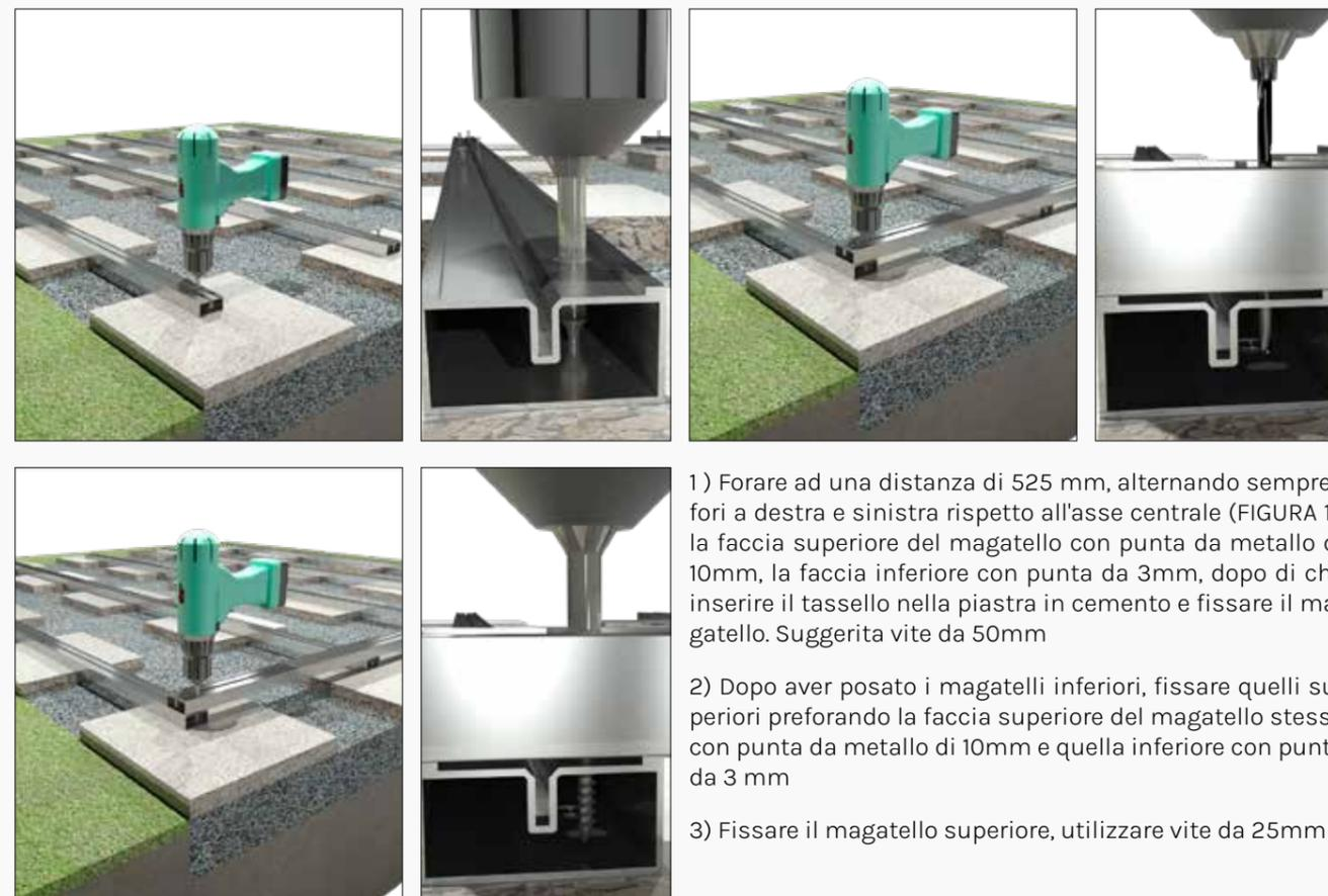
1) Forare ad una distanza di 525 mm, alternando sempre i fori a destra e sinistra rispetto all'asse centrale (FIGURA 1), la faccia superiore del magatello con punta da metallo di 10mm, la faccia inferiore con punta da 3mm, dopo di che inserire il tassello nella piastra in cemento e fissare il magatello. Suggestita vite da 50mm
