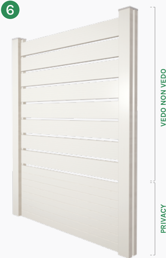
column height H 2050mm, spacing 1520mm 8 doghe VEDO NON VEDO + 4 doghe PRIVACY with standard 20 mm spacer
