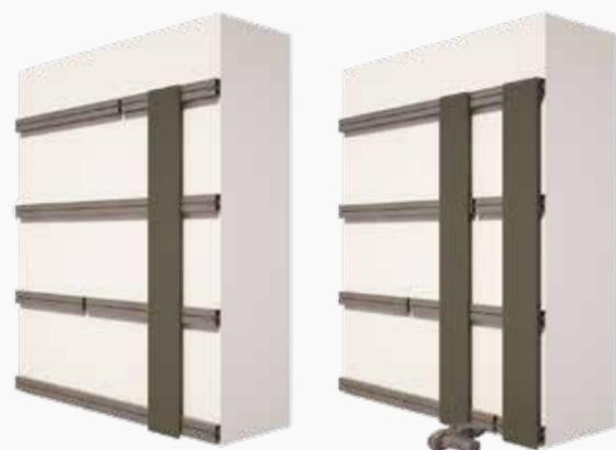
Dopo aver fissato i magatelli usare la clip start usando clip cod. AF602 per fissare la prima dogha, poi continuare l'installazione usando la clip cod. AF601.
