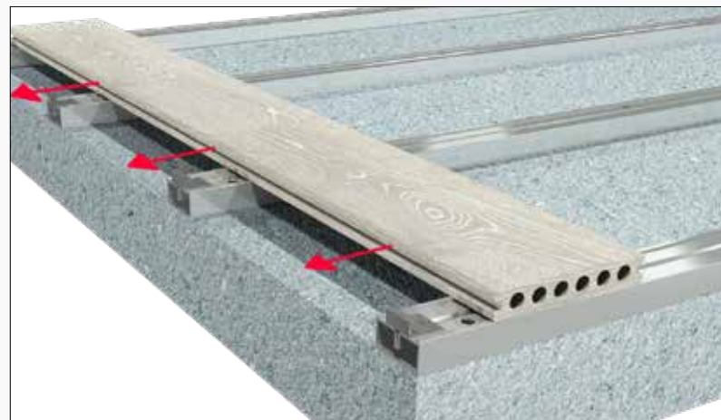
1) Posizionare la doga trasversalmente ai magatelli e spingerla fino al raggiungimento delle "start clips"
