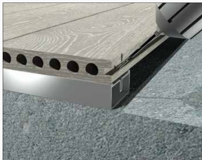
3) Dettaglio foratura magatello ed asola dell'ultima doga
