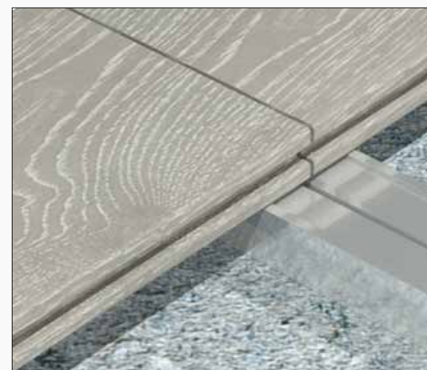
4) Nel caso in cui si rendesse necessaria l'unione di due o più doghe, effettuare la giunzione esattamente al centro della clip
