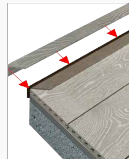
3) Applicare il primo angolare (lato corto) facendolo combaciare correttamente alla doga
